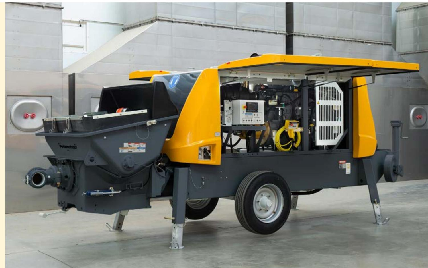
Les portes rabattables permettent un accès simplifié et protègent de la pluie et du soleil durant les travaux à l'intérieur de la machine
