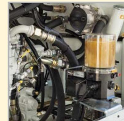
La centrale de graissage électronique fait économiser du temps de travail et diminue l'usure
