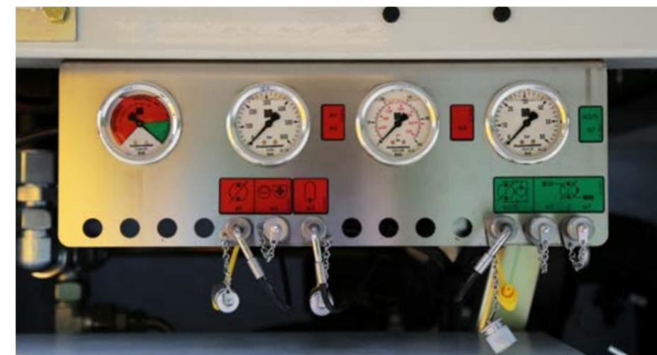
Barre « minimes » : tous les points de mesure hydrauliques sont centralisés (BSA nouvelle génération)
