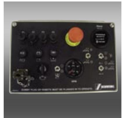
Le panneau de commande pratique comprend des interrupteurs électriques pour marche/arrêt, marche avant/arrière et marche/arrêt de l'agitateur. Le tachymètre et le compteur d'heures sont également situés ici, ainsi que l'arrêt d'urgence, le tableau des fusibles et le commutateur d'allumage.
