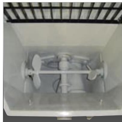
Un nettoyage rapide avec moins de béton gaspillé est un avantage de ces modèles SP par rapport aux autres pompes. L'agitateur de trémie standard maintient l'écoulement du béton vers les cylindres de matériau pour un pompage en douceur même des mélanges les plus durs.
