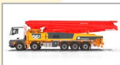
Pompe à béton automotrice M56
